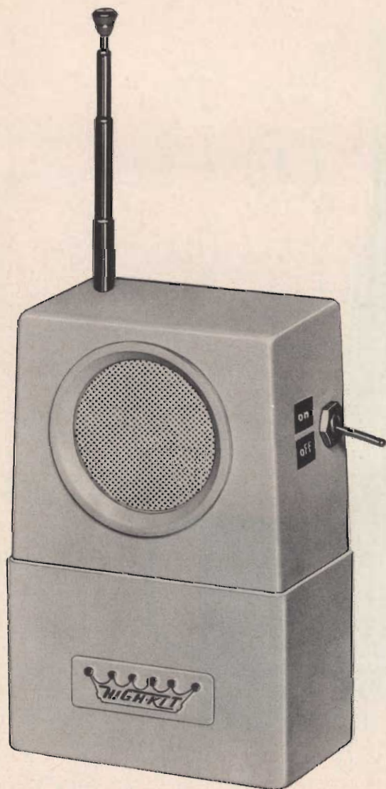
Fig. 5 - Vista del trasmettitore FM a montaggio ultimato.
